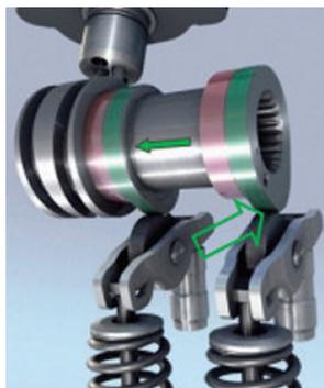
**Рис. 1.** Работают 2 цилиндра
